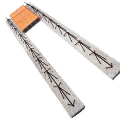
A laje treliçada é composta por vigotas de concreto treliçadas, preenchidas com lajota cerâmica ou EPS (isopor). Possuem alturas variáveis que dependem dos vãos de apoio e da sobrecarga de utilização necessária ao tipo da obra. A montagem pode ser uni ou bidirecional, conforme a necessidade do projeto.
